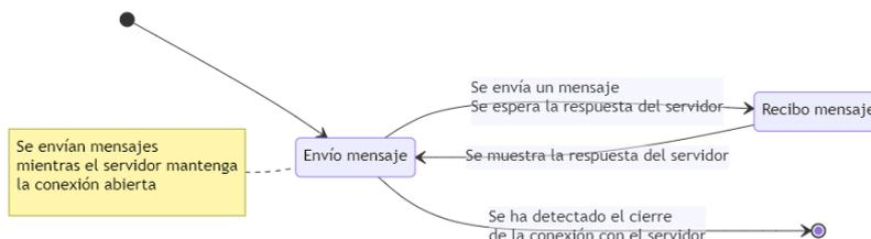
Como ya hemos dicho en el código del servidor, si implementamos el protocolo como un cliente de envío-respuesta, hay un caso en el que no debemos esperar una respuesta. Este es el caso de la salida, en la que se envía un mensaje pero no esperamos respuesta por parte del servidor.
